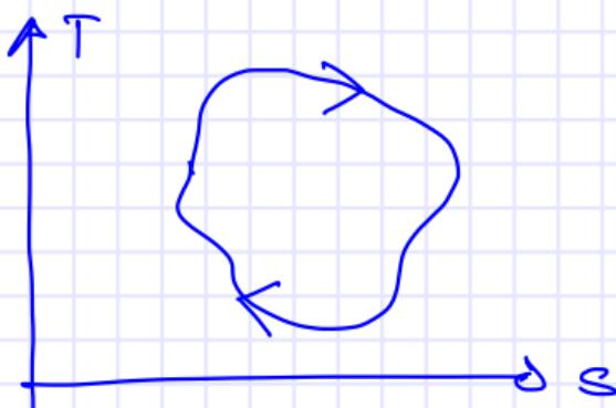
Moteur  $W < 0$  échanges admissibles  $W = \int_{\text{cycle}} -pdV$
