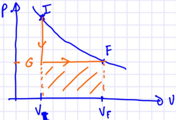
$$V_F > V_I \quad \ln \frac{V_F}{V_I} > 0 \Rightarrow W_{I\rightarrow F} < 0$$
