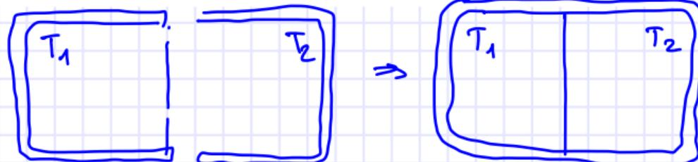
système total isolé constitué de 2 sous systèmes rigides fermés
