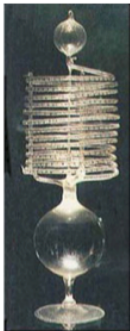
Thermomètre à dilatation de gaz Galilée 1592
