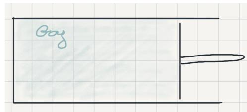
Les isothermes sont réalisées par des transformations lentes, en contact avec un des bains thermiques. Les adiabatiques sont réalisées par une détente ou une compression assez rapide pour que les échanges thermiques n'aient pas le temps de se mettre en place, mais en garantissant quand même une transformation qui ne se fasse pas hors équilibre, ainsi elle est réversible.
