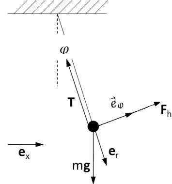
Dans l'approximation des petits angles  $\sin \varphi \approx \varphi$ . On obtient finalement l'équation du mouvement selon  $\vec{e}_\varphi$  (l'équation du mouvement selon  $\vec{e}_\rho$  fait intervenir la force de tension de la corde qui ne nous intéresse pas ici) :
