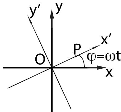
$$\begin{cases} \vec{x}' = (\cos \omega t) \vec{x} + (\sin \omega t) \vec{y} \\ \vec{y}' = -(\sin \omega t) \vec{x} + (\cos \omega t) \vec{y} \end{cases}$$
