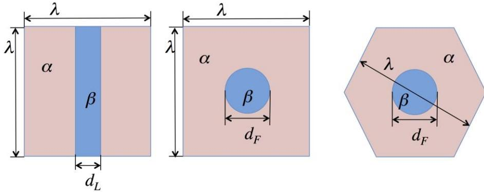
*Schéma des « cellules unitaires » pour les lamelles (à gauche) et les fibres en arrangement carré (au milieu) et en arrangement hexagonal (à droite). La géométrie a une longueur unitaire dans la direction perpendiculaire au plan de dessin.*
