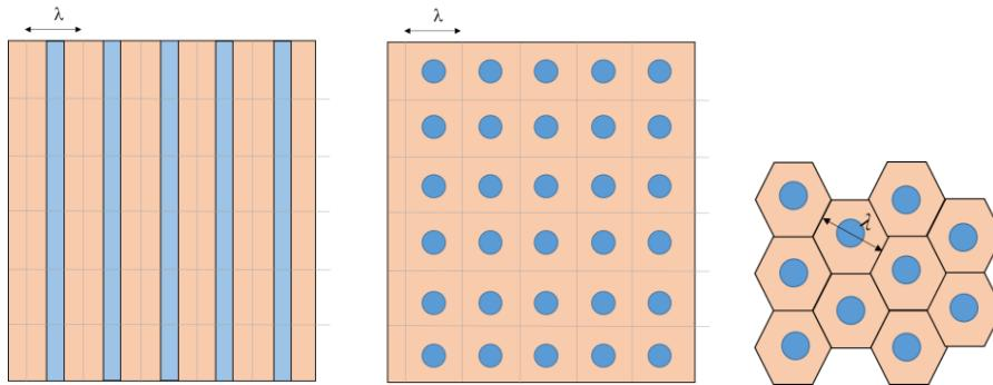
*Schéma des microstructures faites à partir des « cellules unitaires »*
