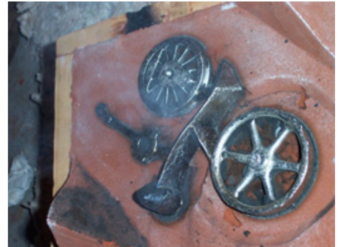
Principe de coulée en sable avec deux châssis et un noyau.
