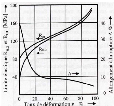
Le métal écroui (= déformé plastiquement) voit sa limite à la rupture et sa limite élastique à 0.2 % augmenter alors que sa ductilité diminue.  $R_m$  et  $R_{0.2}$  sont multipliés par 2 et 4 respectivement à 90% de taux de déformation.
