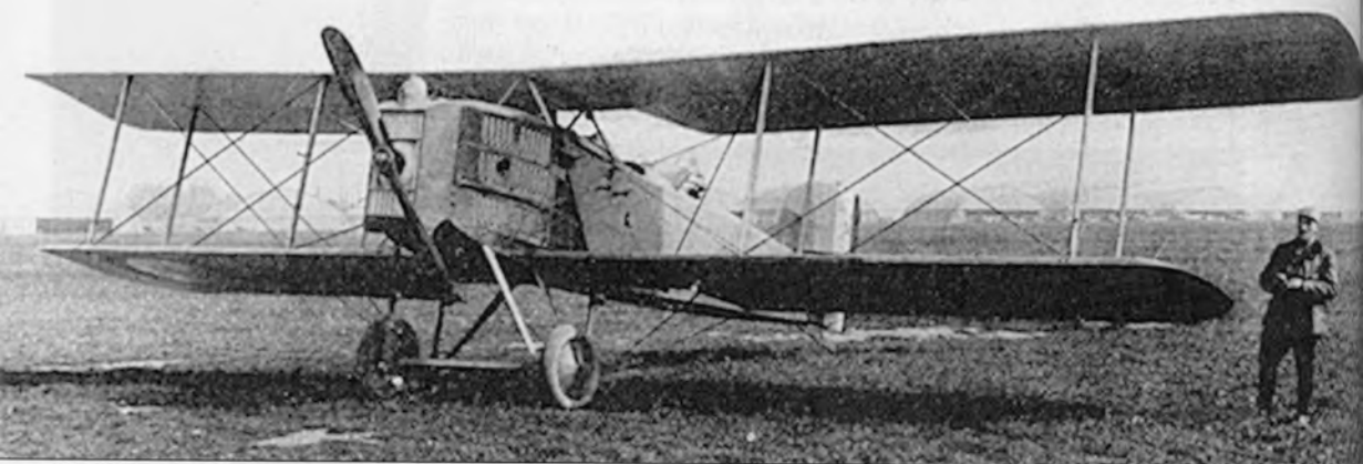
Fig. 8 – Le Breguet XIV A2 mis en chantier en juin 1916, premier avion au monde comportant une structure résistante en Duralumin.
