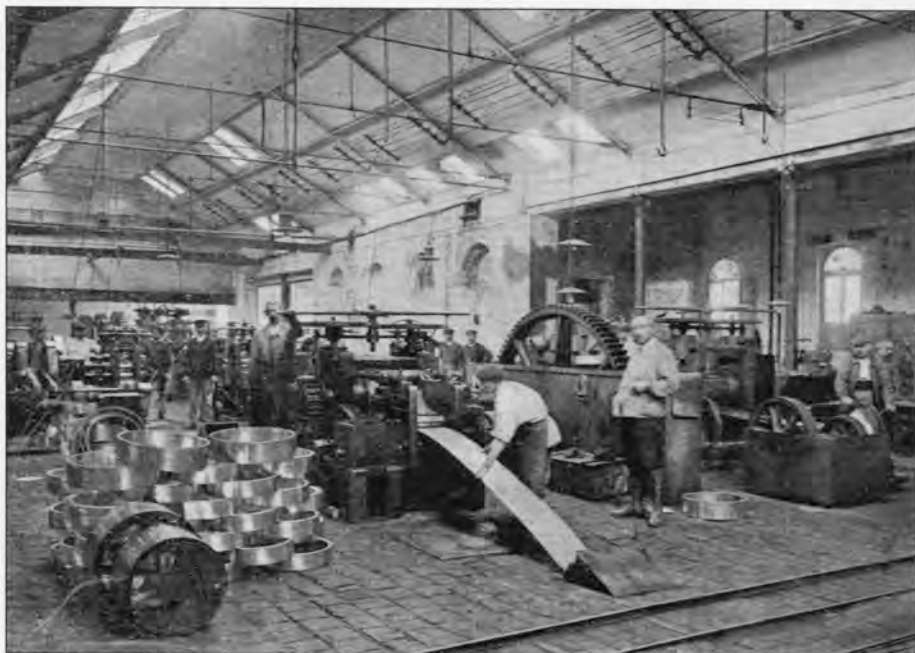
Fig. 3 – Usine de la Société du Duralumin (concessionnaire depuis 1911 des brevets Wilm) - Atelier de laminage des bandes. (R.A. n°5, 1925)
