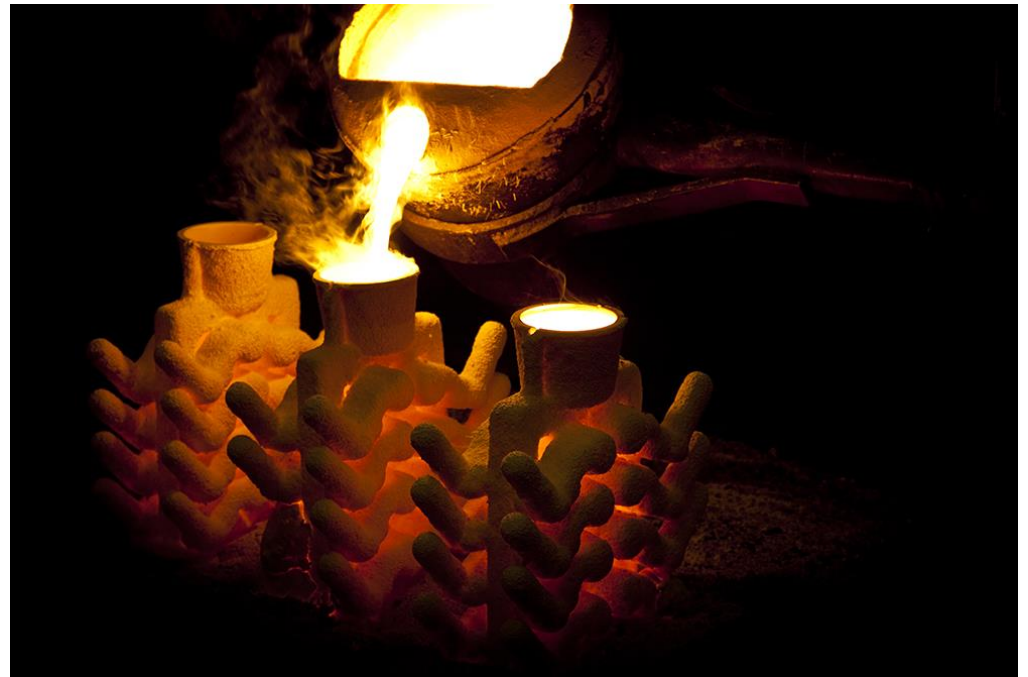
Coulée d'un superalliage base-Ni dans un moule
