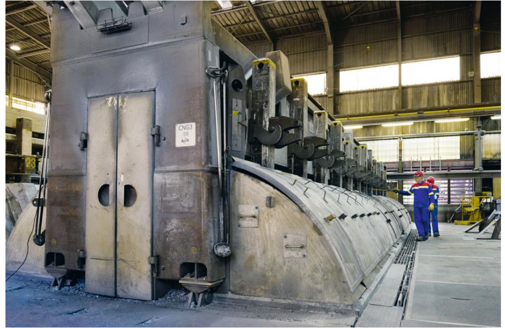
Electrolyse de \text{Al}_2\text{O}_3 dans une cuve avec une anode en C
