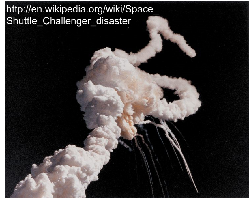
Explosion de la navette Challenger au décollage (28.1.1986) due à un O-Ring défectueux et des basses températures .
