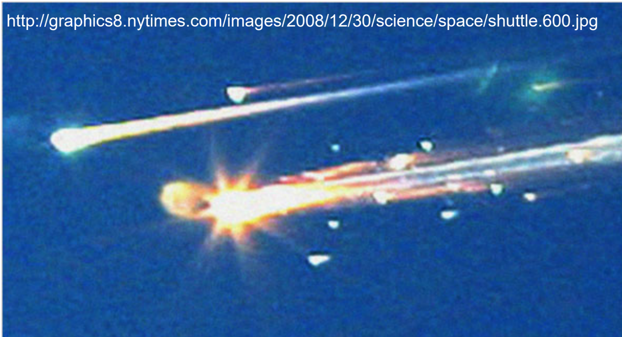
Explosion de la navette Columbia (1.2.2003) lors de sa rentrée dans l'atmosphère, à cause de son bouclier thermique endommagé au décollage.
