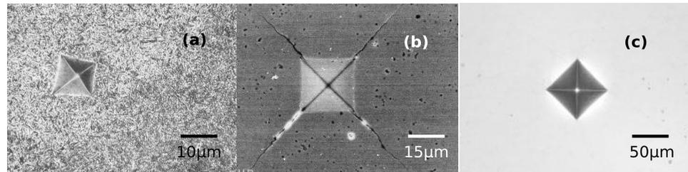
Une valeur de dureté 9 sur l'échelle de Mohs correspond (voir les transparents du cours) à 2000 HV (dureté Vickers). A la force appliquée  $F = 10 \text{ N}$  correspondra une empreinte avec une diagonale moyenne de :
