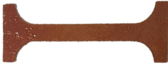
Figure 3: Photo d'une éprouvette de traction normalisée fabriquée dans le laboratoire SuNMIL.
