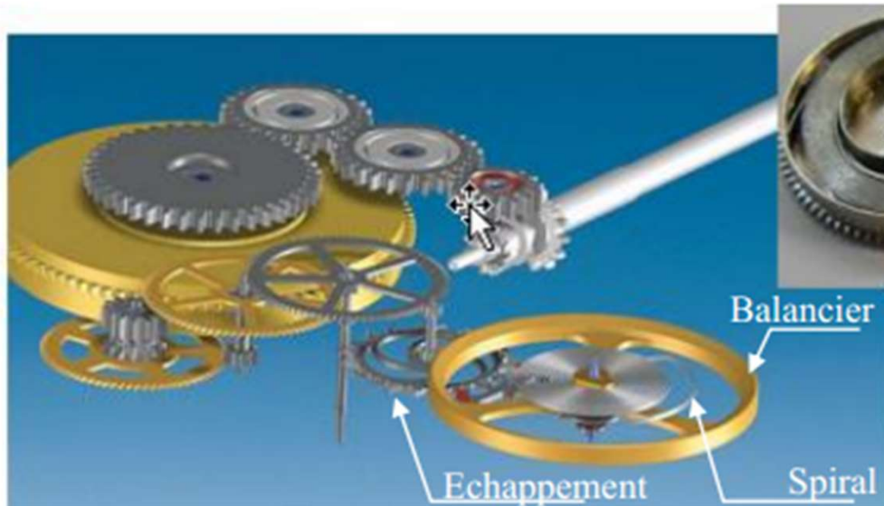
Fig. Ressort de barillet (à gauche) qui fournit l'énergie stockée – L'oscillateur (balancier, spiral et l'échappement) règle le débit.
