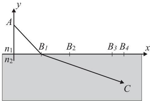
On a les coordonnées  $(x; y)$  suivantes pour les points dans le schéma ci-dessus :  $A = (0; 100)$ ,  $B_1 = (48.9; 0)$ ,  $B_2 = (97.7; 0)$ ,  $B_3 = (173.2; 0)$ ,  $B_4 = (195.5; 0)$  et  $C = (195.5; -100)$ . Les indices de réfraction sont  $n_1 = 1$  et  $n_2 = 4$  ; toutes les distances sont en mètres.
