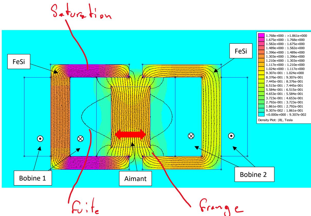
La figure ci-dessus représente la simulation par éléments finis d'un actionneur. La partie mobile se déplace horizontalement (flèche rouge).
