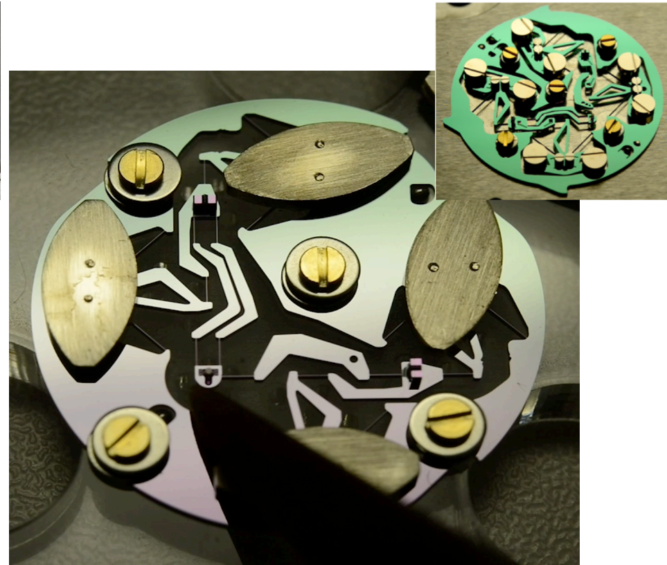
2- DOF «Wattwins» flexure oscillator
