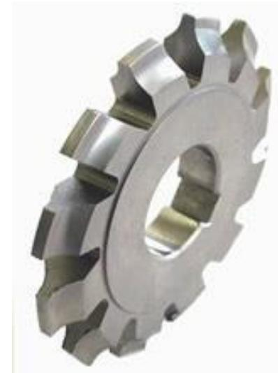
Taillage par fraise de forme (fraise module):
