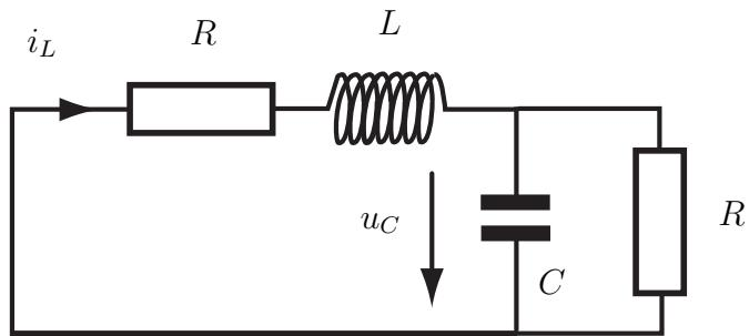
avec comme paramètres physiques  $R = 1 \text{ [k}\Omega\text{]}$ ,  $C = 33 \text{ [nF]}$ , et  $L = 1 \text{ [\mu H]}$  et
