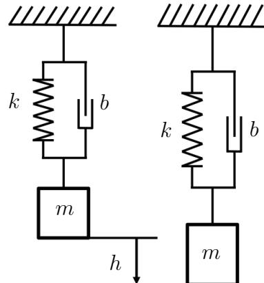
avec comme paramètres physiques  $m = 0.2 \text{ [kg]}$ ,  $k = 100 \text{ [N/m]}$  et  $b = 0.01 \text{ [Ns/rad]}$ .
