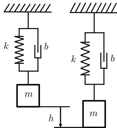
avec comme paramètres physiques  $m = 0.2 \text{ [kg]}$ ,  $k = 100 \text{ [N/m]}$  et  $b = 0.01 \text{ [Ns/rad]}$ .
