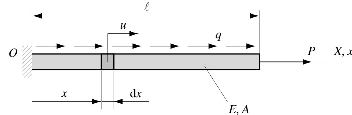
Barreau prismatique encastré soumis à une charge répartie axiale et une force ponctuelle longitudinale
