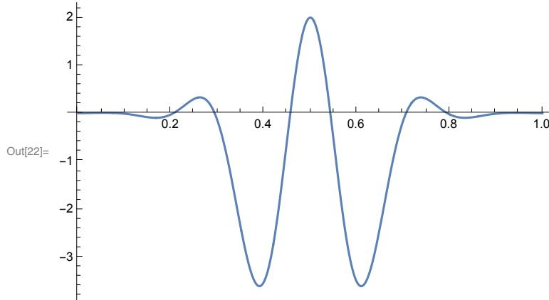
On constate que le signal est continue à gauche et à droite de la fenêtre (en considérant que ce signal est prolongé à gauche et à droite par la valeur constante 0)
