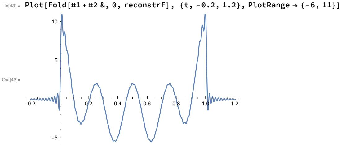
L'approximation ne provient pas du mauvais choix de la période d'échantillonnage, mais de la nature tronquée du signal de départ: il ne part pas du temps - infini et il ne finit pas au temps + infini. Il n'a donc pas un contenu fréquentiel à bande limitée. Il ne satisfera jamais aux conditions du théorème d'échantillonnage !
