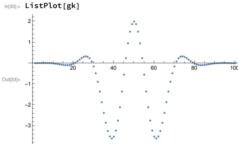
On construit les sinc décalés sur chaque instant d'échantillonnage
