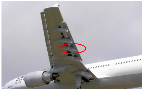
Mécanisme de flaps pour A320
