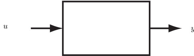
Figure 3.2. Un système avec une entrée u et une sortie y .
