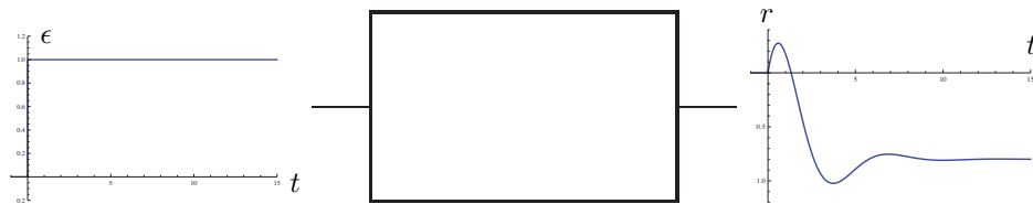
Figure 3.3. Un saut indiciel, également appelé saut unité ou saut de Heaviside, est un signal qui est nul pour t < 0 et égal à 1 pour t \geq 0 .
