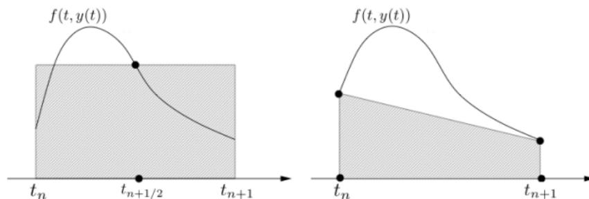
En utilisant la formule du trapèze, on trouve le schéma implicite suivant, appelé **schéma de Crank-Nicolson ou du trapèze** :
