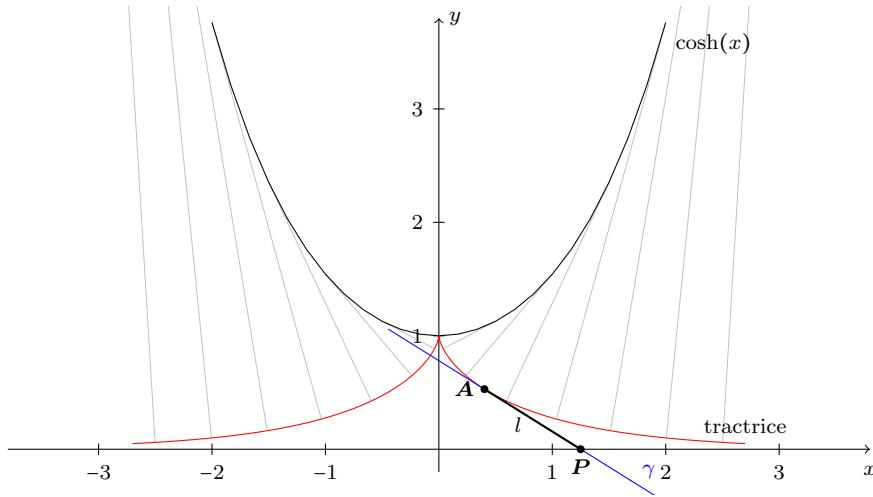
(b) L'équation de la droite tangente en un point  $A(x(a), y(a))$ , de la tractrice est :
