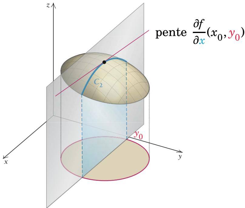
L'ensemble de tous les points de  $\mathbb{R}^3$  tels que  $y = y_0$  est un plan parallèle au plan  $0xz$  qui coupe le graphe de  $f$  le long de la courbe  $C_2$ . La pente de la droite tangente à la courbe  $C_2$  au point  $(x_0, y_0, f(x_0, y_0))$  est la dérivée partielle  $\frac{\partial f}{\partial x}(x_0, y_0)$ .
