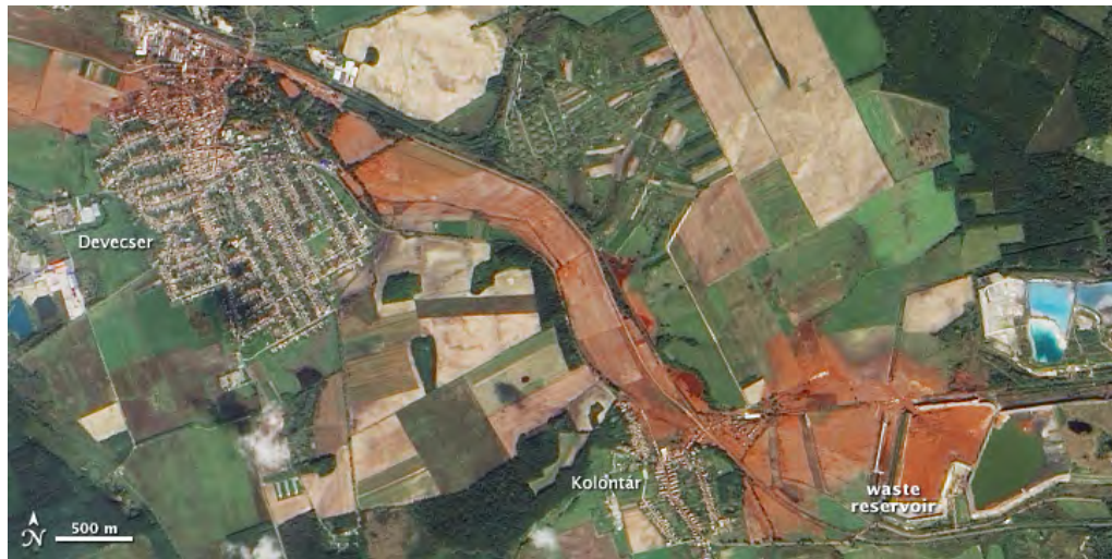
Figure 2.42 – Zones inondées par la rupture du bassin de décantation de l’usine d’Akja en Hongrie. Photographie satellitaire prise le 9 octobre 2010. Source : NASA .
