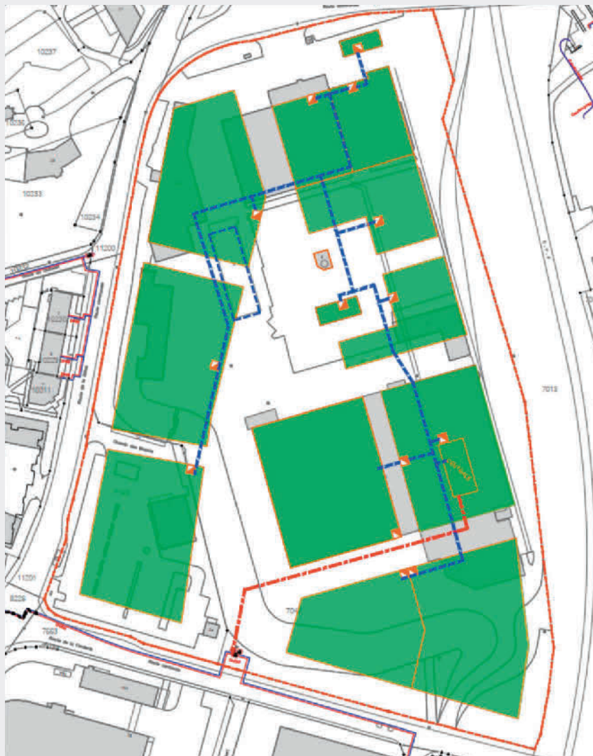
Fig. 8 Schéma des réseaux énergétiques du site. En bleu: tracé des réseaux basse température (BT) et moyenne température (MT), vision 2040. En rouge: raccordement au réseau de chauffage à distance de la ville de Fribourg (CAD-FR)
