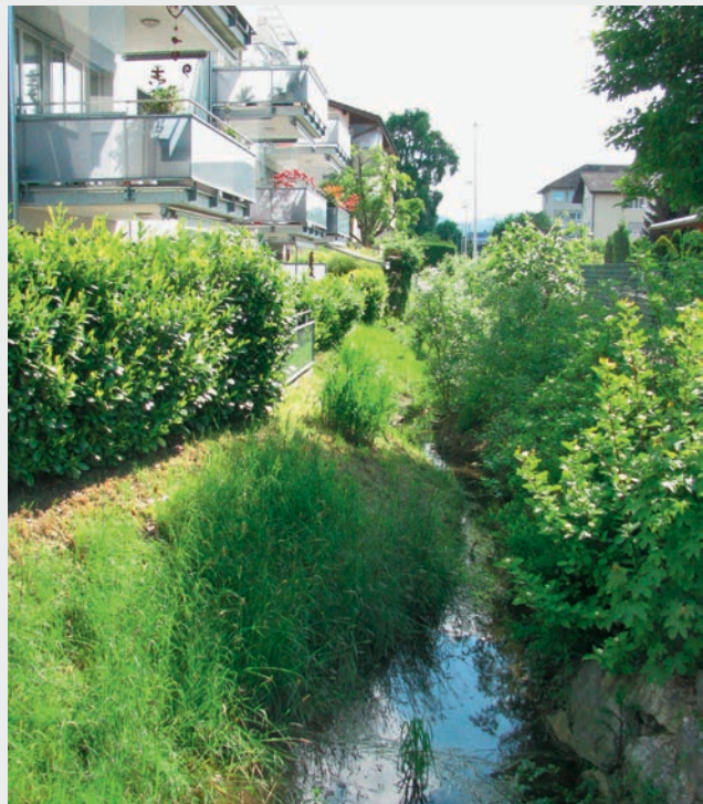
Fig. 5 La commune d'Ostermundigen a fait remettre en surface le cours d'eau anciennement enterré Lötchenbach. En cas de précipitations intensives, l'eau des trop-pleins des grands bassins d'infiltration s'y déverse également.
