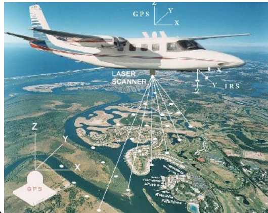
Fig. 2.10 Principe de l'acquisition de l'altimétrie par balayage laser (© Swisstopo).
