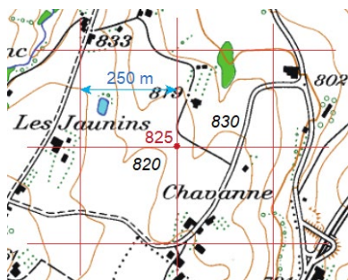
Fig. 2.15 Numérisation par estimation visuelle – Mode de création du modèle RIMINI à maille de 250 m. L'altitude 825 m est estimée par l'opérateur en référence aux courbes de niveau 820 et 830 (extrait de la carte 1223, © Swisstopo).
