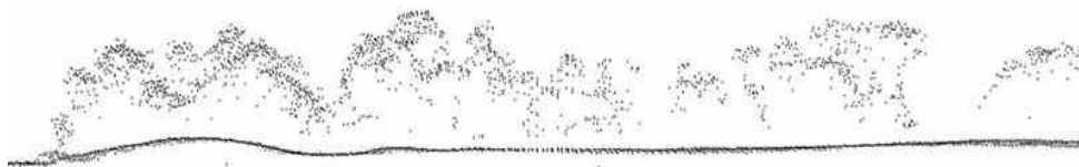
Fig. 2.12 Profil vertical d'échos laser. MNS : enveloppe supérieure ; MNT ou MNA : enveloppe inférieure.
