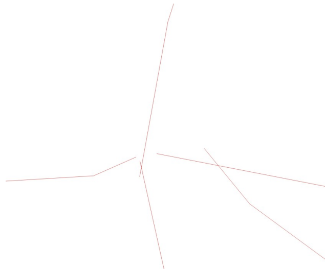
Figure 2: Erreur topologique : Mauvaises intersections aux croisements
