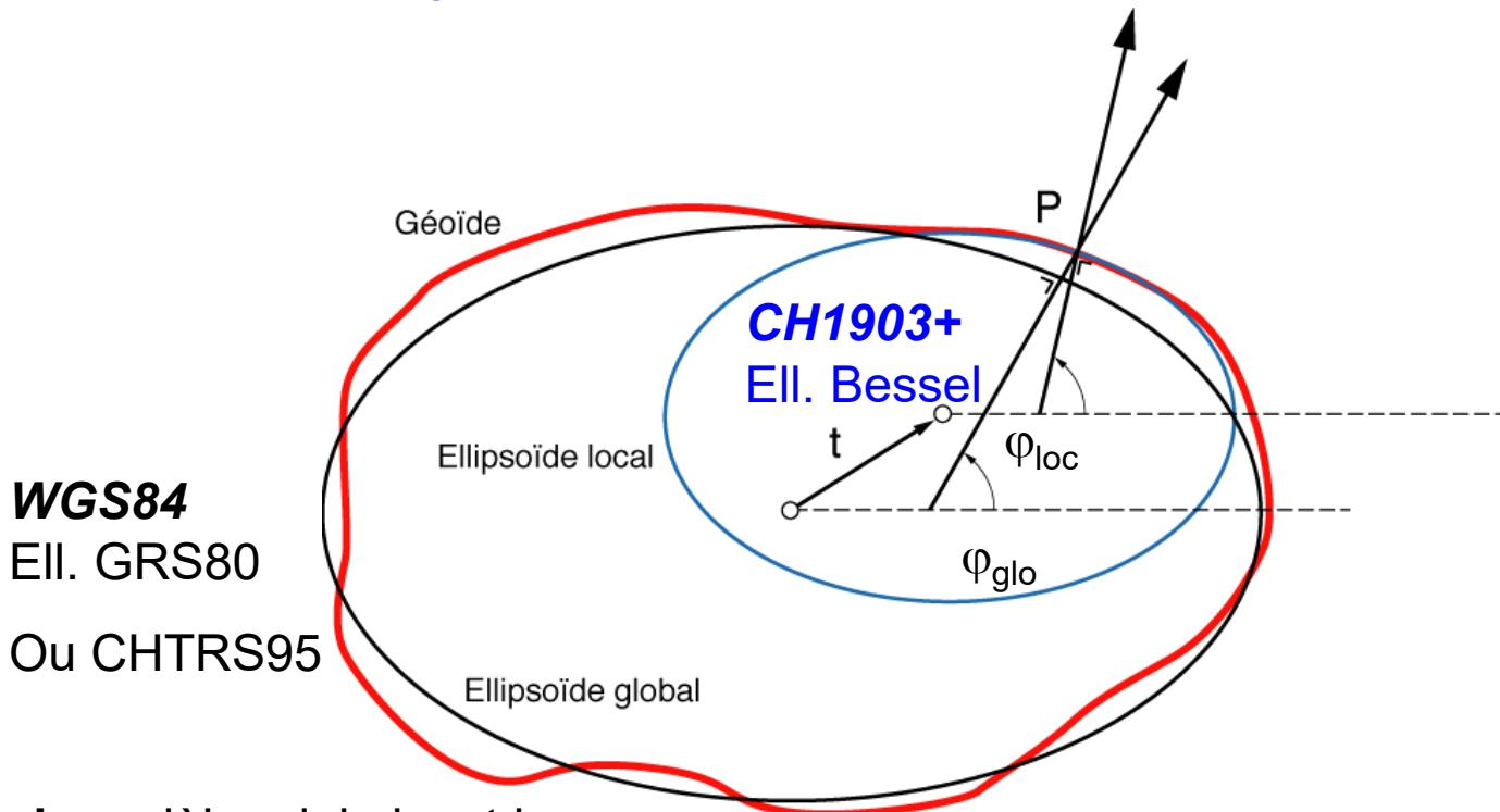
**Ellipsoïde global:** modèle minimisant les écarts avec le géoïde sur l'ensemble de la Terre
