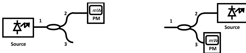
Figure 8 : Mesure (a) des pertes de la voie 2 et (b) de la directivité.
