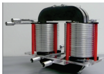
FAU-EN: 450kW, 5.6kHz
