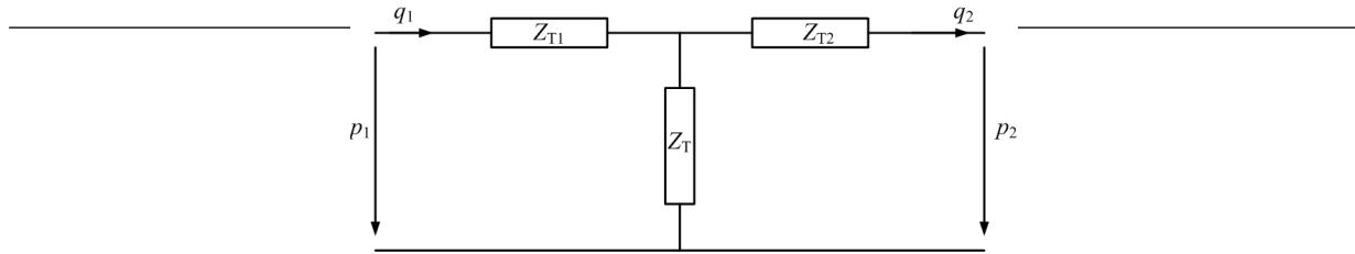
3. Si  $q_2 = 0$ , la branche du circuit en T avec l'impédance  $Z_{T2}$  est en circuit ouvert, d'où le schéma suivant :
