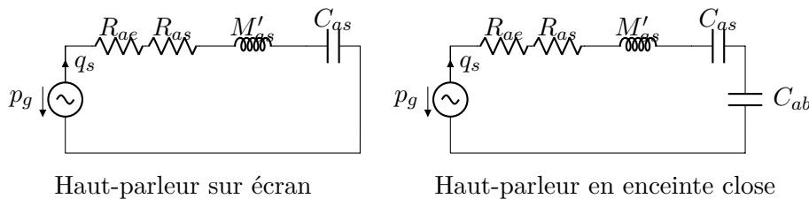
On peut définir le rapport de compliances  $\alpha = \frac{C_{as}}{C_{ab}} = \frac{V_{as}}{V_{ab}}$ .
