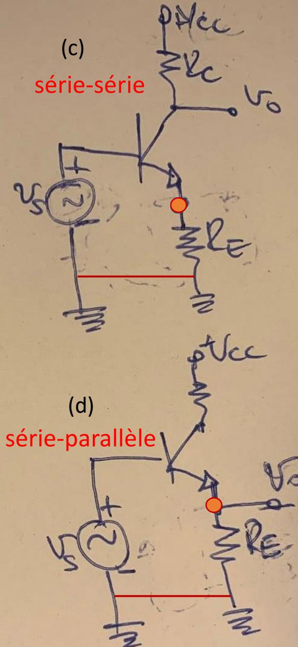
Notez que le EC dégénéré (c, d) est un cas particulier de RN car le signal retourné à l'entrée du TB a travers  $R_E$  et la masse
