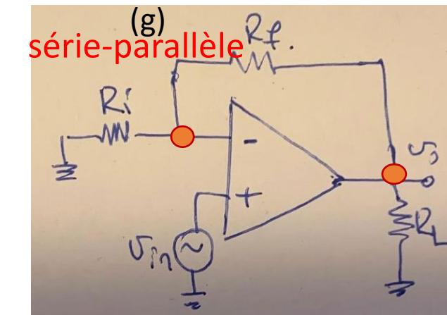
Remarquez que le circuit de réaction n'est pas connecté directement à l'entrée de l'ampli op, car le signal d'entrée est sur l'entrée positive. Ainsi, il y a une connexion en série à l'entrée.
