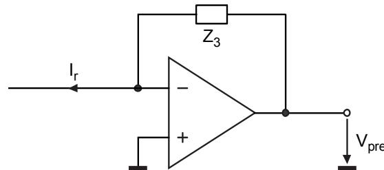
L'impédance complexe utilisée en contre-réaction de l'amplificateur vaut:
