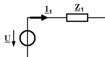
Dans un second temps, on ajoute une capacité  $C$  en série avec l'impédance  $Z_1$  et on mesure alors un  $\cos\phi = 0,6$ .
