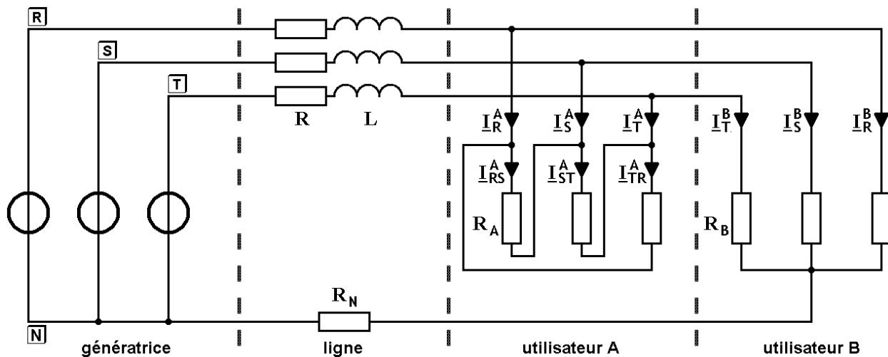
Une génératrice triphasée idéale impose un système triphasé symétrique de tensions simple de valeur efficace  $U$ , à une fréquence  $f$ . Elle alimente deux utilisateurs triphasés symétriques à travers une ligne de longueur  $d$ , dont chaque conducteur de phase présente une résistance linéaire  $R'$  et une inductance linéique  $L'$ .
