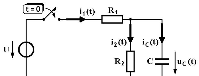
Application numérique :  $R_1 = 10 \Omega$      $R_2 = 15 \Omega$      $C = 10 \mu\text{F}$
