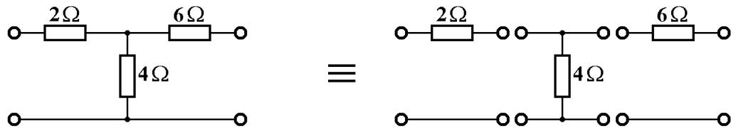
$$[T] = \begin{bmatrix} 1 & 2 \\ 0 & 1 \end{bmatrix} \cdot \begin{bmatrix} 1 & 0 \\ 1/4 & 1 \end{bmatrix} \cdot \begin{bmatrix} 1 & 6 \\ 0 & 1 \end{bmatrix} = \begin{bmatrix} 3/2 & 22/2 \\ 1/4 & 5/2 \end{bmatrix} = \begin{bmatrix} A & B \\ C & D \end{bmatrix}$$
