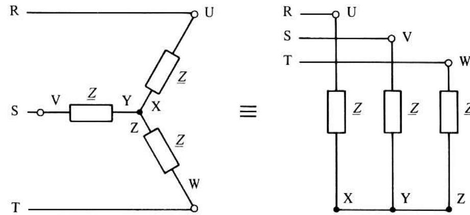
Les tensions de phase se confondent avec les tensions simples
