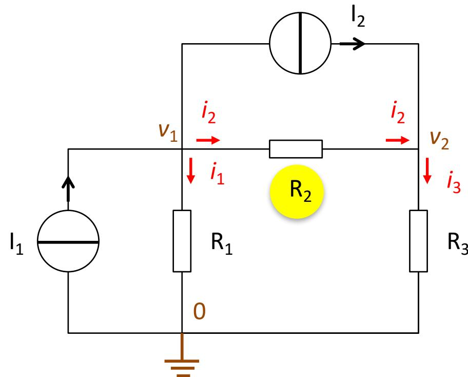
Conductance connectée entre les nœuds 1 et 2, avec un signe -.
