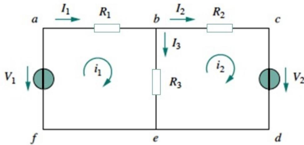
$$I_1 = i_1 \quad I_2 = i_2 \quad I_3 = i_1 - i_2$$
