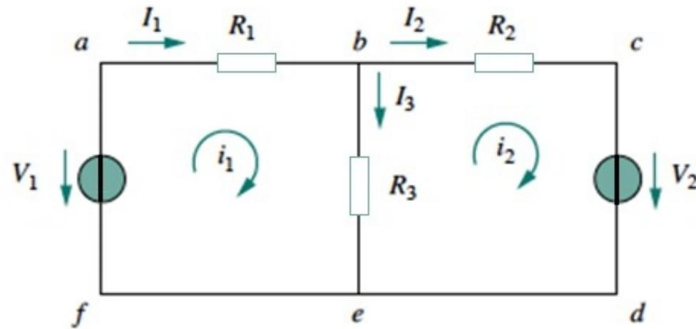
$$\begin{bmatrix} R_1 + R_3 & -R_3 \\ -R_3 & R_2 + R_3 \end{bmatrix} \begin{bmatrix} i_1 \\ i_2 \end{bmatrix} = \begin{bmatrix} V_1 \\ -V_2 \end{bmatrix}$$
