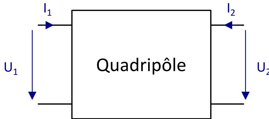
$$\begin{bmatrix} U_1 \\ U_2 \end{bmatrix} = \begin{bmatrix} Z_{11} & Z_{12} \\ Z_{21} & Z_{22} \end{bmatrix} \begin{bmatrix} I_1 \\ I_2 \end{bmatrix} \Leftrightarrow \begin{cases} U_1 = Z_{11}I_1 + Z_{12}I_2 \\ U_2 = Z_{21}I_1 + Z_{22}I_2 \end{cases}$$
