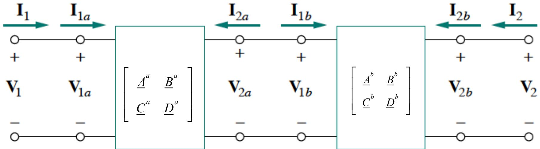
$$\begin{bmatrix} A & B \\ C & D \end{bmatrix} = \begin{bmatrix} A^a & B^a \\ C^a & D^a \end{bmatrix} \begin{bmatrix} A^b & B^b \\ C^b & D^b \end{bmatrix}$$
