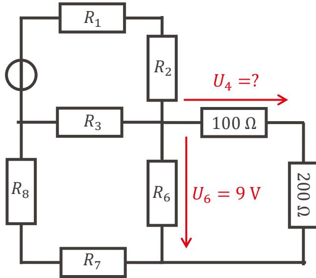
Les résistances de  $100\ \Omega$  et  $200\ \Omega$  sont en série: **on peut appliquer le diviseur de tension**
