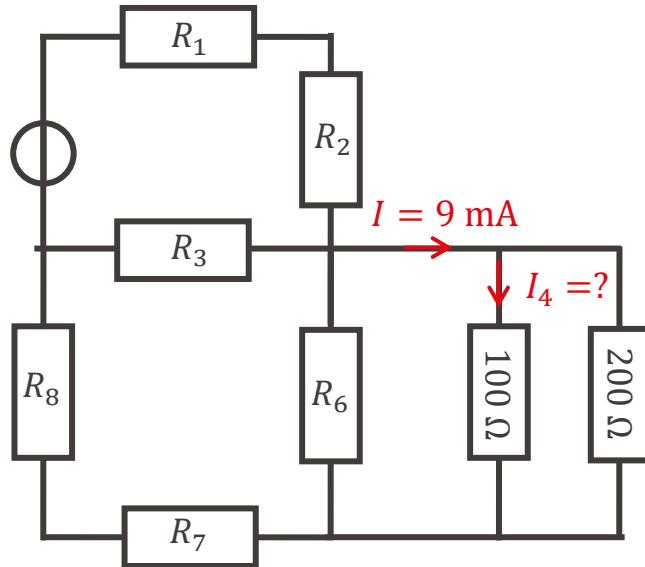
Les résistances de  $100\ \Omega$  et  $200\ \Omega$  sont en parallèle: **on peut appliquer le diviseur de courant**
