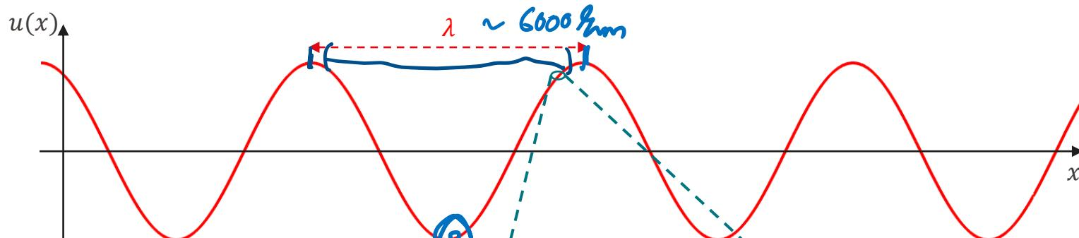
Exemple: réseau électrique (50 Hz):
