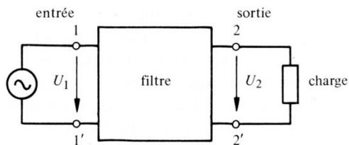
Lorsque la tension d'entrée  $U_1$  est sinusoïdale, la transmission à travers le filtre dépend de fréquence  $f$  :
