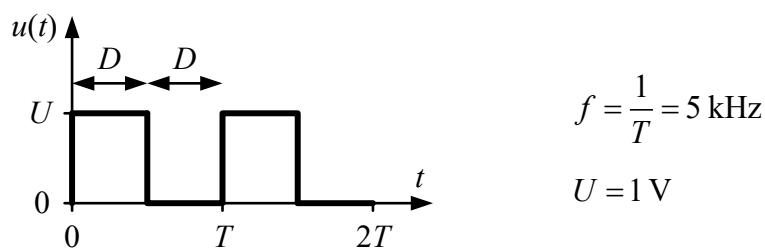
Utiliser les paramètres ci-dessous pour configurer le générateur de fonctions **HMF2525**.
