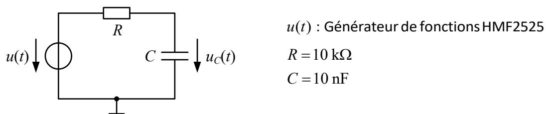
La tension  $u(t)$  fournie par le générateur de fonctions **HMF2525** est un signal rectangulaire de fréquence  $f = 500 \text{ Hz}$  et d'amplitude  $U = 1 \text{ V}$  :
