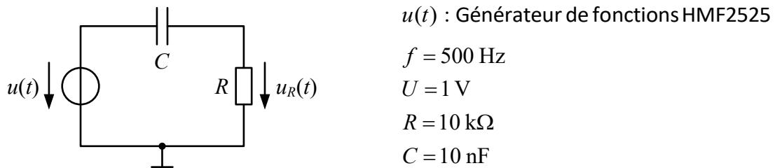
Visualiser les tensions  $u(t)$  et  $u_R(t)$  à l'oscilloscope.
