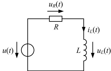
La tension  $u(t)$  fournie par le générateur de fonctions est un signal rectangulaire de fréquence  $f$  et d'amplitude  $U$  :
