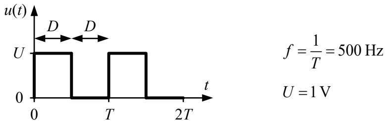
Pour obtenir la tension  $u(t)$  ci-dessus, le générateur de fonctions **HMF2525** va effectuer la somme des deux signaux suivants :
