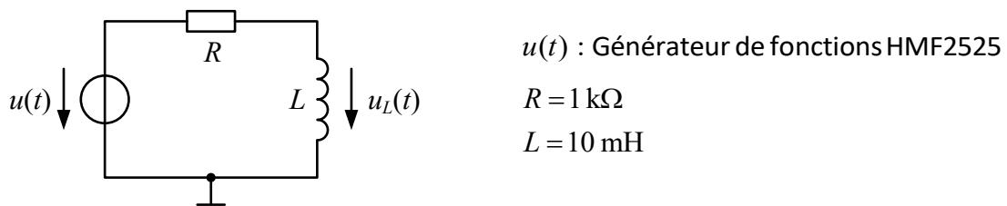
La tension  $u(t)$  fournie par le générateur de fonctions **HMF2525** est un signal rectangulaire de fréquence  $f = 5 \text{ kHz}$  et d'amplitude  $U = 1 \text{ V}$  :
