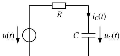
La tension  $u(t)$  fournie par le générateur de fonctions est un signal rectangulaire de fréquence  $f$  et d'amplitude  $U$ :
