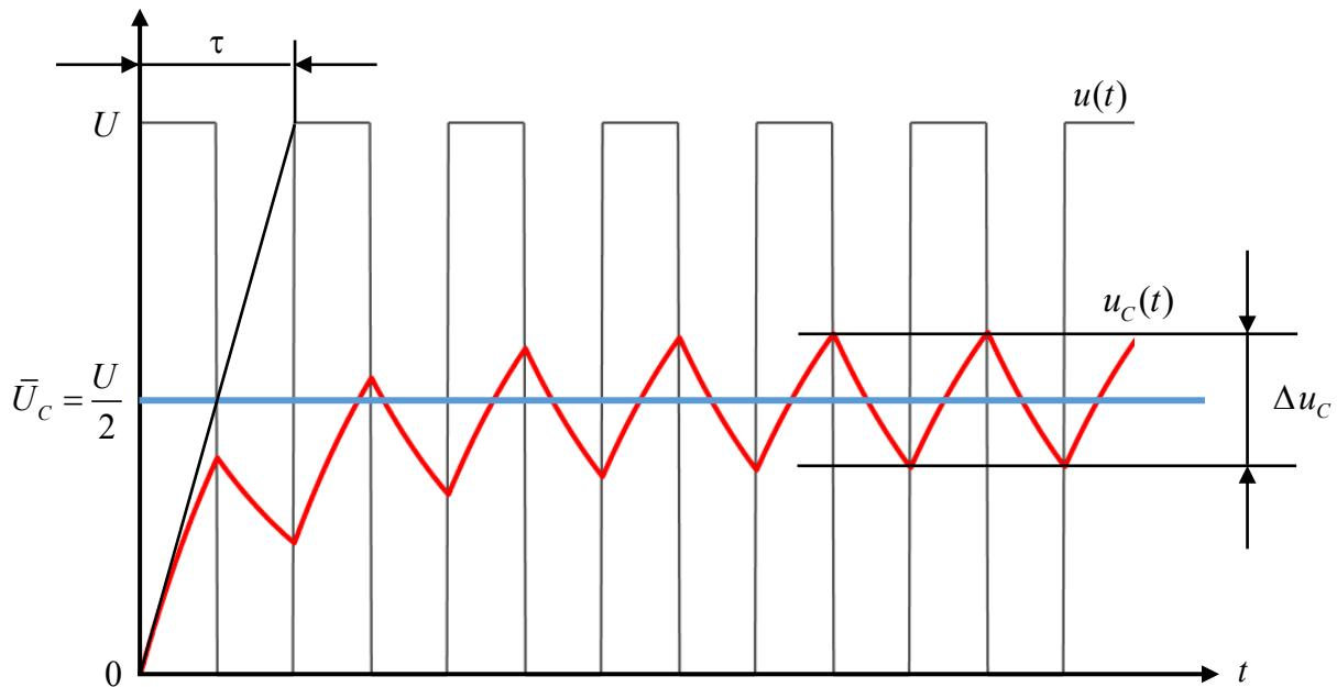
La tension  $u_C(t)$  est en forme de dent de scie.
