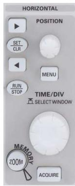
La zone **HORIZONTAL** permet de choisir les paramètres de la base de temps :
