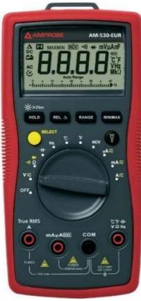
Enclencher le multimètre **AM-530-EUR** et contrôler l'exactitude des 3 valeurs affichées par le générateur de fonctions.
