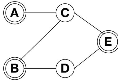
Vous souhaitez construire un système de diagnostic qui permet de détecter des pannes de composants de ce réseau sur la base d'observations de transmissions entre noeuds. Seuls les noeuds terminaux (A, B et E) sont accessibles. On suppose que les seules pannes possibles sont des pannes des noeuds (p. ex. C, D) ou des liens (p. ex. A-C, B-D), et que ces éléments tombent en panne indépendamment. Une panne se manifeste par le fait que les communications par un certain chemin ne passent pas.
